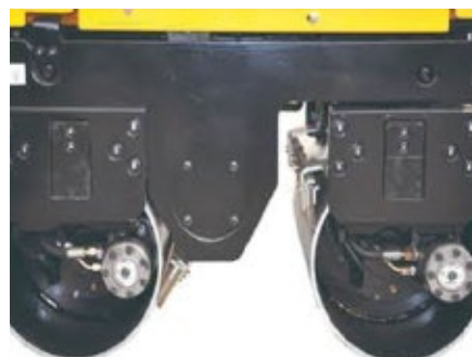
Los motores hidráulicos ciclooidales de marca americana impulsan la máquina
