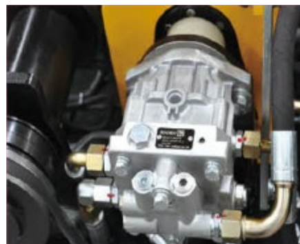
La bomba de émbolo variable de servicio ligero impulsa la máquina de forma continua
