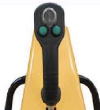
Marcha adelante/atrás, dirección izquierda/derecha y vibración, todo controlado por la palanca de control integrada
